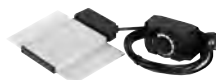
RÉSISTANCE AVEC RÉGULATEUR DE TEMPÉRATURE HEATING ELEMENT - HEAT ADJUSTABLE RESISTENCIA CON REGULADOR DE TEMPERA 202860 - 220 /240 V /200 W 203468 - 110 /120 V 20 X 20 CM - 7 IN 7/8 X 7 IN 7/8
